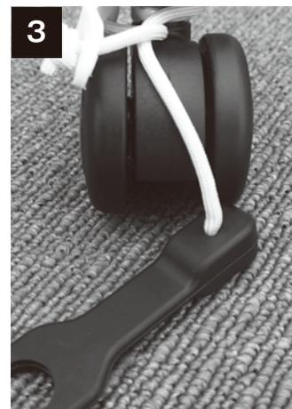
衝撃吸収ベルトを引き、高強度ロープを絞るように、キャスターの付け根部分にくくり付けます。
