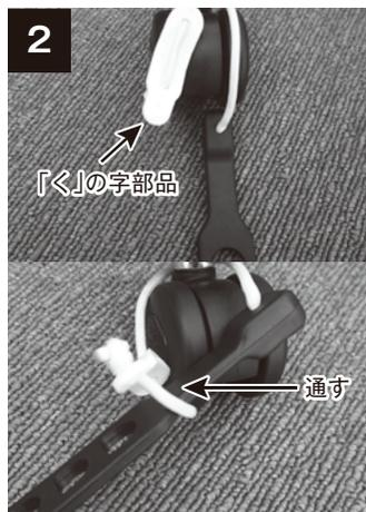
高強度ロープをキャスターの付け根部分に巻き、衝撃吸収ベルトを自在カギ(「く」の字部品)の真ん中に、先端から通します。
